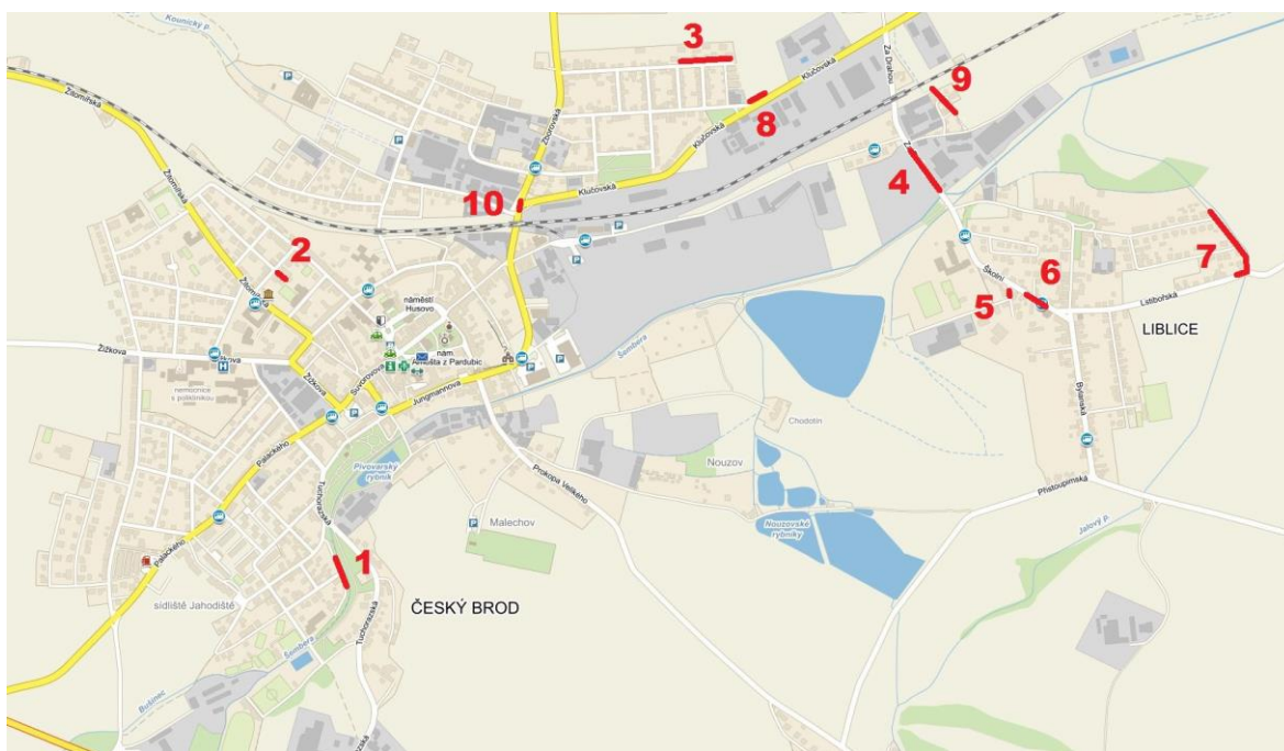
Obrázek č.5: Místa s problémovým povrchovým odtokem vod
